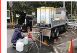
←仮設水槽からの応急給水
